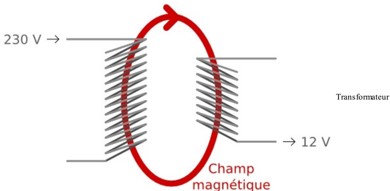
La première bobine reçoit le courant de tension 230 V, ce qui génère un champ magnétique. Ce champ magnétique induit alors un courant dans la seconde bobine, dont la tension est inférieure. En jouant sur le nombre de spires des deux bobines, on peut parvenir à induire un courant de tension voulue dans la seconde bobine. Le tour est joué ! Enfin presque.
