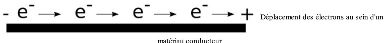
Mais le courant électrique ne se balade pas sans encombre sur son fil (ou son matériau conducteur quel qu'il soit). Il lui est opposé une **résistance** dans sa progression, qui dépend notamment de la forme et de la longueur du fil, ainsi que du matériau utilisé. La résistance est exprimée en ohms ( $\Omega$ ).
