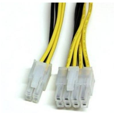
Connecteur d'alimentation ATX 8 broches ou ATX-P4
